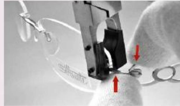
1. Sujetar firmemente la fijación de la lente con los alicates de montaje.
