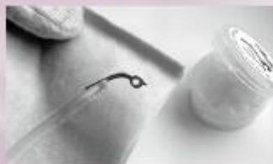
Engrasar el interior del hueco de la bisagra con el lubricante de alta precisión. Si es necesario, limpiarlo antes. Poner los BLS. Montar la varilla.
